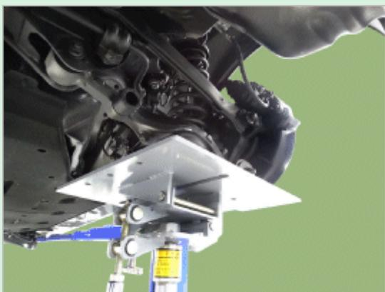
6. 拧下固定螺栓&螺母，从副车架上拆卸下臂 (A)。
