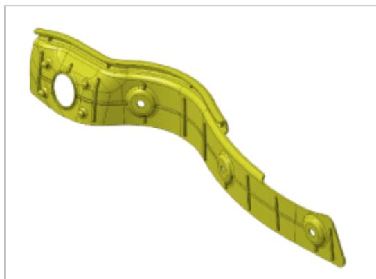
4. 拧下下臂 (A) 固定螺栓和螺母。然后从后支架上拆卸下臂。
